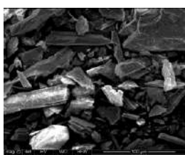
Figura 4: MEV antes do Selfrag (1000x). Figura 5: MEV após o Selfrag (1000x)
