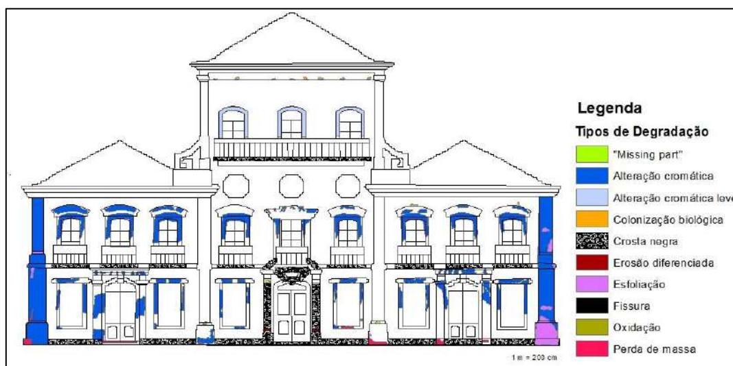
Figura 2. Mapeamento das morfologias de alteração das rochas que compõem a fachada do prédio do Paço Imperial, do Rio de Janeiro. Feito com software ArcGis10.
