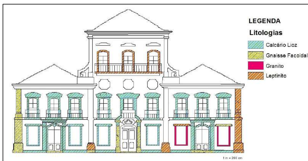
Figura 1. Mapeamento das litologias que compõem a fachada principal do prédio do Paço Imperial. Feito com o software ArcGIS no programa ArcMap10.
